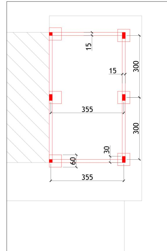
DETALHE FUNDAÇÕES DEPÓSITO - SAPATAS E
