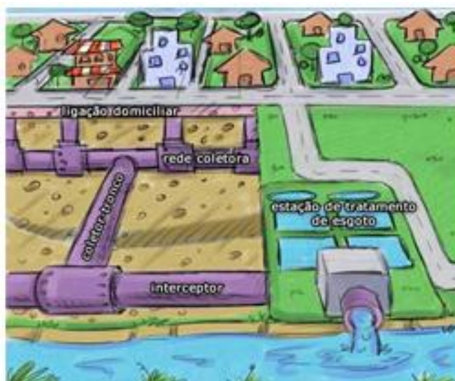
Figura 3 – Sistema de Esgotamento Sanitário
