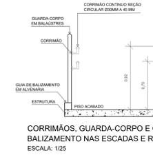
**CORRIMÕES, GUARDA-CORPO E GUIA DE BALIZAMENTO NAS ESCADAS E RAMPAS**
