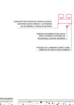
**DETALHE 03 - INSTALAÇÃO DA LUMINÁRIA DE EMERGÊNCIA TIPO BLOCO AUTÔNOMO**
