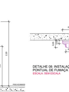
**DETALHE 08: INSTALAÇÃO DO DETECTOR PONTUAL DE FUMAÇA**
