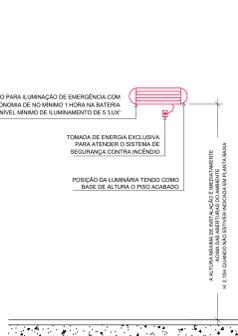
**DETALHE 02 - INSTALAÇÃO DA LUMINÁRIA DE EMERGÊNCIA TIPO BLOCO AUTÔNOMO**
