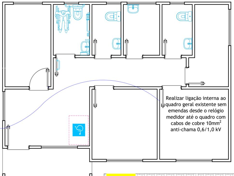
Realizar ligação interna ao quadro geral existente sem emendas desde o relógio medidor até o quadro com cabos de cobre 10mm<sup>2</sup> anti-chama 0,6/1,0 kV
